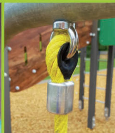
Cordage Hercule constitué de 6 torons, dont l'âme acier tressé est gainée de fibre polyester à une résistance à la rupture de 3.9 tonnes.
