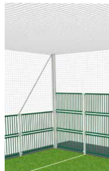
Filet en toiture
