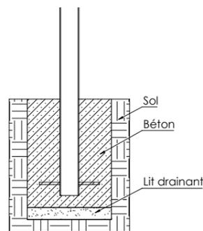
Dans le cas où le sol de sécurité est de faible épaisseur nous pouvons sceller directement la pièce et recouvrir le béton de sol amortissant.
