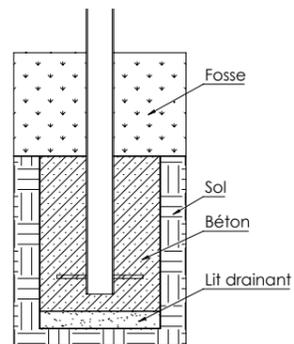
Dans le cas d'un sol fluide nous devons tenir compte de la surépaisseur qu'il représente (jusqu'à 40 cm). La longueur des pièces de scellement est alors adaptée.
